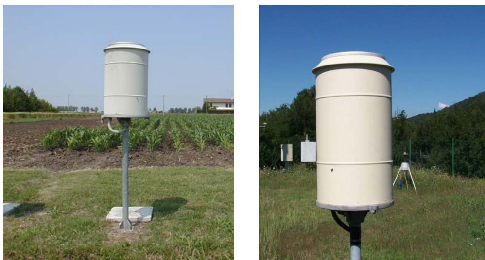
Figura 4-1 - Vista d'insieme del pluviometro e del corpo contenente i dispositivi di misura.
