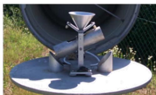
Figura 4-4– Simulazione del movimento delle vaschette basculanti del pluviometro.
