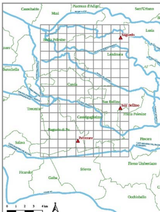
Figura 6-3– Suddivisione del comprensorio oggetto di indagine in maglie quadrate di 1 km di lato per la misura delle precipitazioni e Coefficienti di riduzione spaziale delle precipitazioni per piogge di durata di 1, 2, 3 e 4 ore calcolati con l'ausilio del radar meteorologico per un comprensorio in Provincia di Rovigo.
