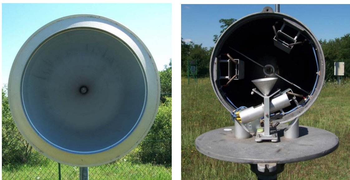
Figura 4-2 – Vista della bocca del pluviometro e particolare del sistema di misura del pluviometro.
