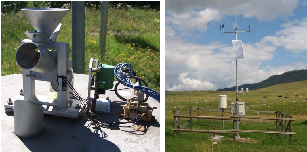
Figura 4-5 – Sul castello di supporto del gruppo basculante (a sinistra) è visibile uno dei due elementi dell'interruttore magnetico. Il componente elettronico di colore verde è il sistema di controllo della temperatura in grado di attivare il gruppo di resistenze per lo scioglimento della neve, e vista d'insieme (a destra) della stazione meteorologica automatica di Marcesina (Enego VI). Oltre alla precipitazione vengono rilevati: temperatura e umidità relativa dell'aria, radiazione globale, direzione e velocità vento. Il contenitore bianco ospita il data logger, le componenti di alimentazione elettrica ed il sistema radio di trasmissione dati.
